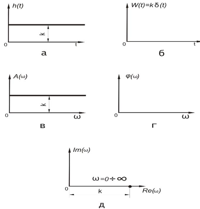
Рисунок 6.1 – Временные и частотные характеристики безынерционного звена:
