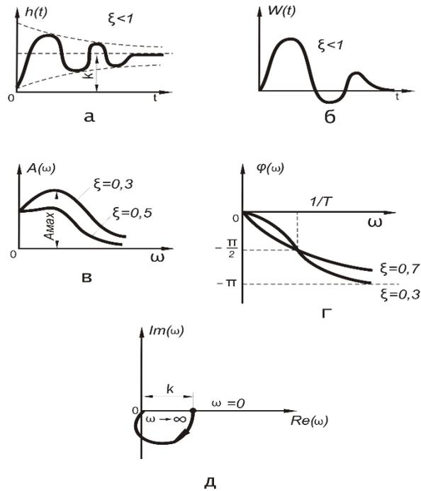
Рисунок 6.4 – Временные и частотные характеристики колебательного звена:
