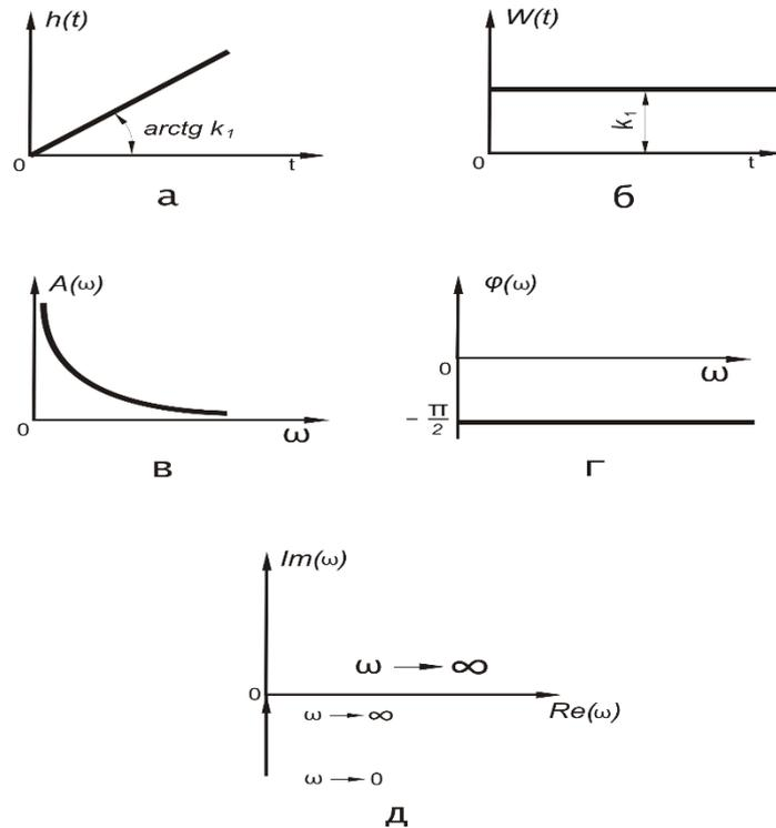
Рисунок 6.2 – Временные и частотные характеристики идеального интегрирующего звена:
