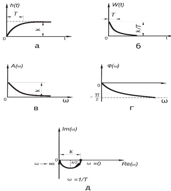
Рисунок 6.3 – Временные и частотные характеристики аperiodического звена 1-го порядка:
