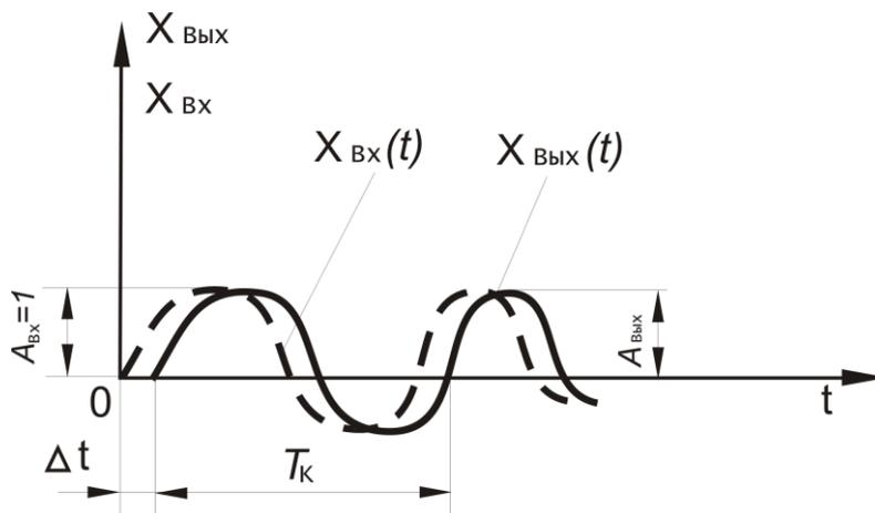
Рисунок 5.2 – Входной и выходной гармонические сигналы объекта управления
