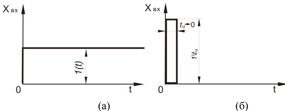
Рисунок 5.1 – Единичное (а) ступенчатое и (б) импульсное воздействия
