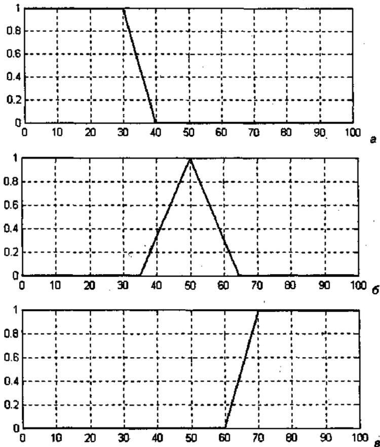
Рисунок 1 – Графики функций принадлежности нечетких множеств  $A_1, A_2, A_3$ , соответствующих нечетким переменным  $\alpha_1 =$  "малая скорость" (а),  $\alpha_2 =$  "средняя скорость" (б),  $\alpha_3 =$  "высокая скорость" (в) для лингвистической переменной  $\beta_1$  (скорость движения автомобиля)
