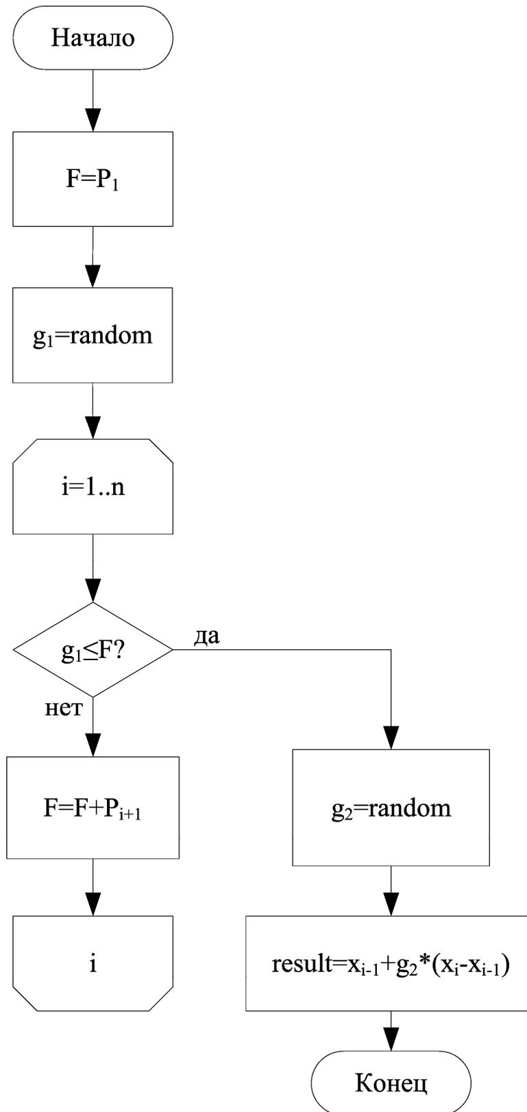
Рис. 5.16. Блок-схема алгоритма моделирования случайной величины, закон распределения которой задан в виде гистограммы:
