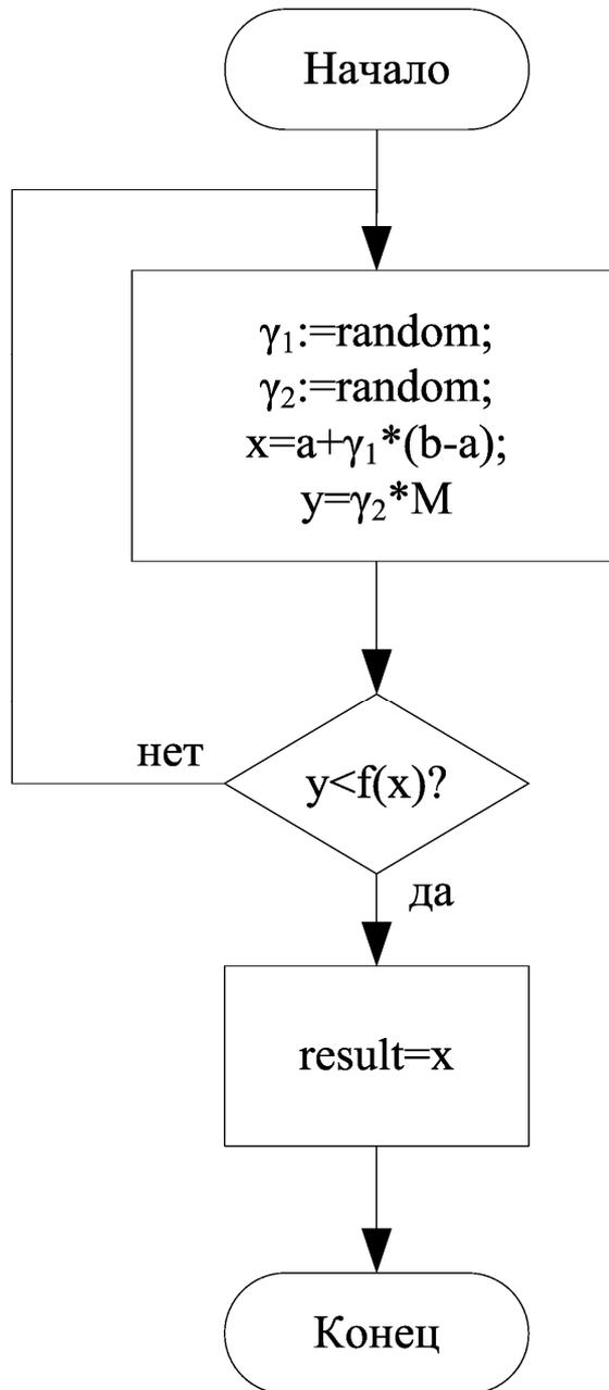
Рисунок 7 – Блок-схема алгоритма Неймана
