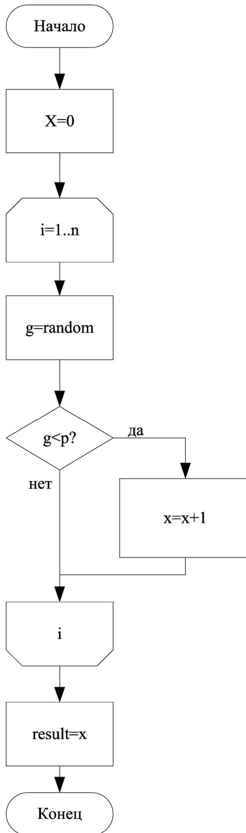
Рисунок 10 – Блок-схема алгоритма моделирования биномиального распределения
