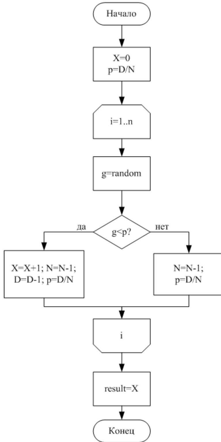
Рис. 5.14. Блок-схема алгоритма моделирования гипергеометрического распределения
