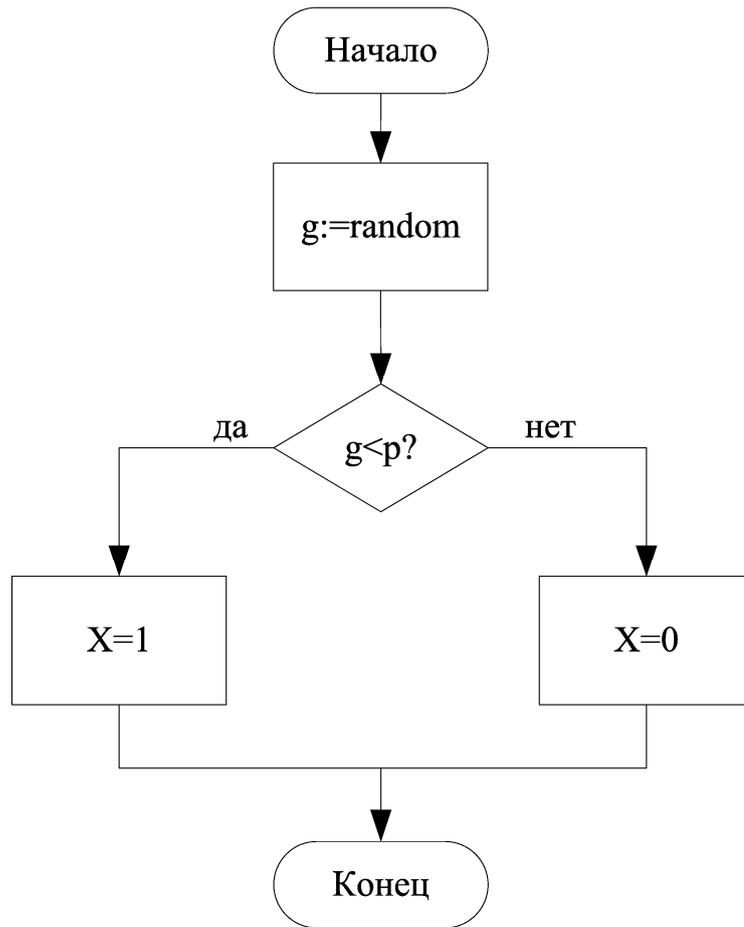
Рисунок 1 – Блок-схема моделирования случайного события
