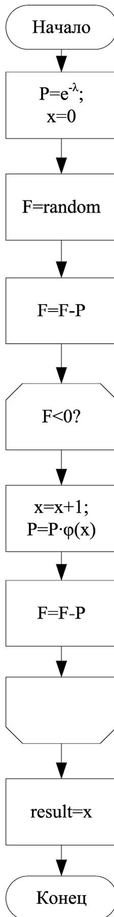
Рисунок 7 – Блок-схема второго варианта подпрограммы-функции моделирования распределения Пуассона
