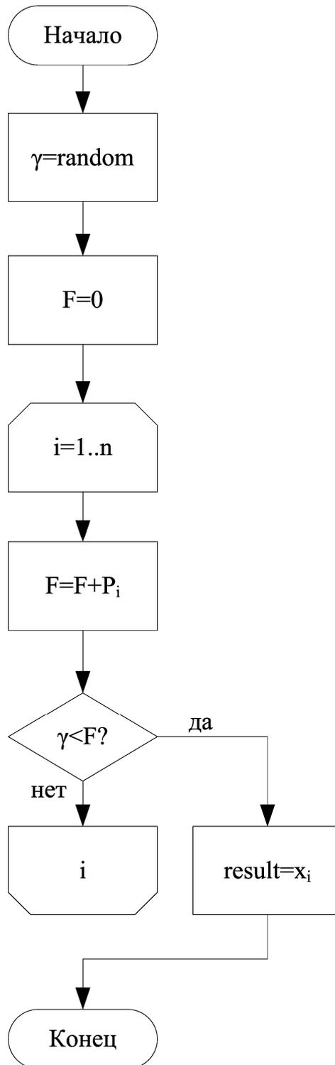
Рисунок 4 – Блок-схема подпрограммы-функции, генерирующей при каждом обращении новое значение дискретной случайной величины  $X$  без хранения накопленной вероятности  $F$
