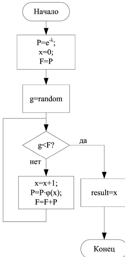
Рисунок 6 – Блок-схема первого варианта подпрограммы-функции моделирования распределения Пуассона
