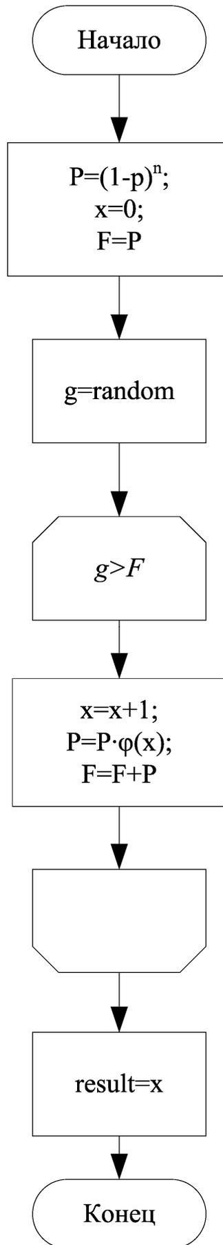
Рисунок 8 – Блок-схема алгоритма моделирования биномиального распределения
