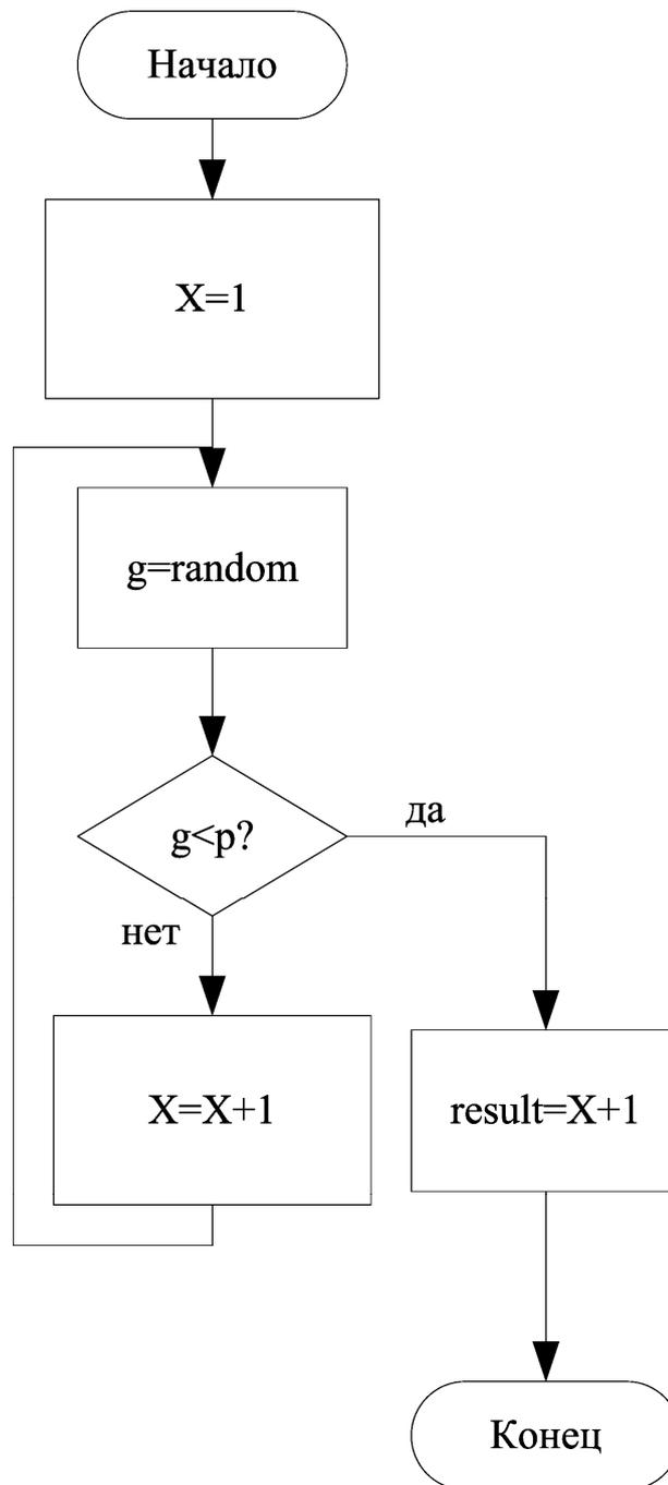
Рисунок 11 – Блок-схема алгоритма моделирования геометрического распределения
