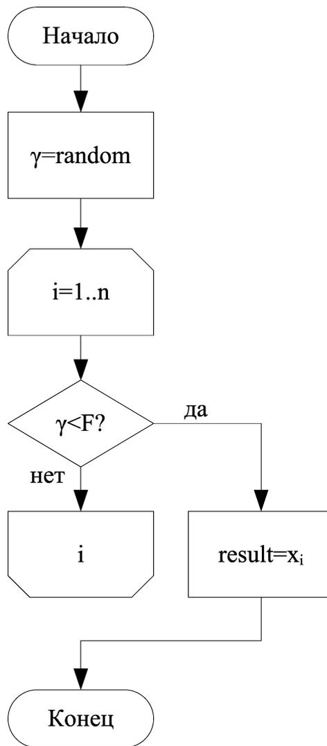
Рисунок 5 – Блок-схема подпрограммы-функции, генерирующей при каждом обращении новое значение дискретной случайной величины  $X$  с заранее рассчитанной накопленной вероятности  $F$
