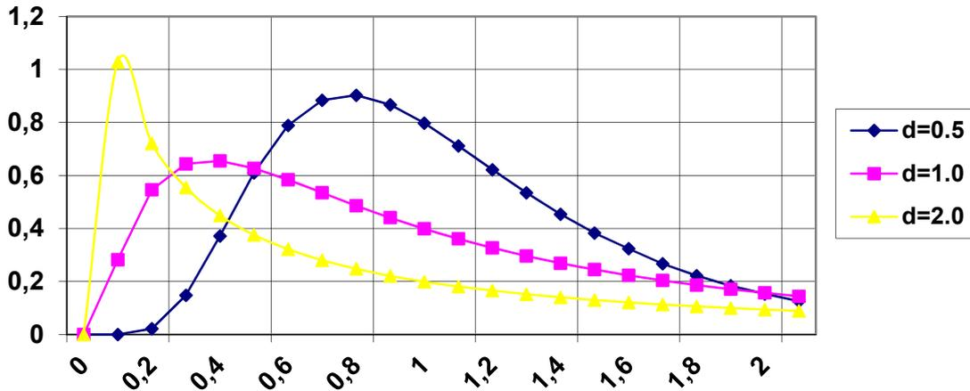
Рисунок 15.3 – График плотности логарифмически нормального распределения при значениях параметров:  $a=1.0$ ,  $d=(0.5, 1.0, 2.0)$
