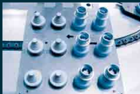
12-позиционный поддон для упорядоченного сбора литых соединительных элементов
