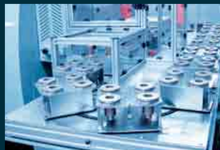
20 поддонов на рольганге со специальными креплениями
